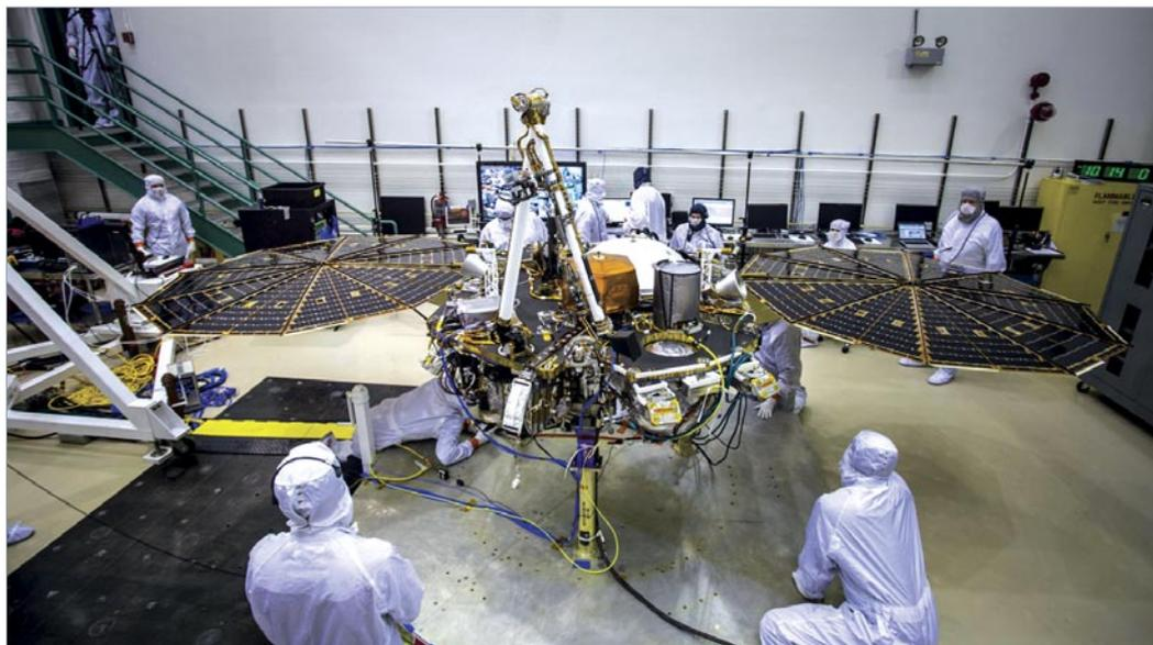
la fase di integrazione e si prepara alla campagna di test assai impegnativi: lavorando nei pressi del Sole, la luce che inonderà la sonda Esa sarà 12 volte più intensa di quella che arriva sulla Terra, con temperature che supereranno i 500 gradi.
