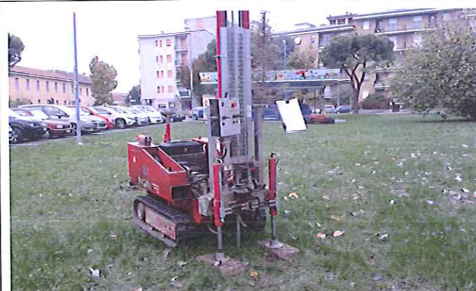
Foto 4: prova penetrometrica dinamica "P4"
