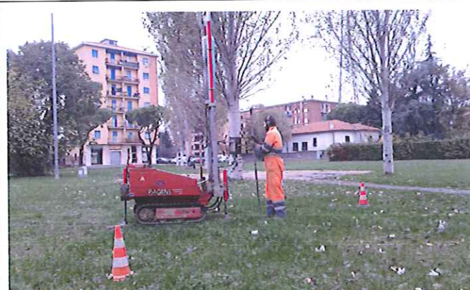
Foto 3: prova penetrometrica dinamica "P3"
