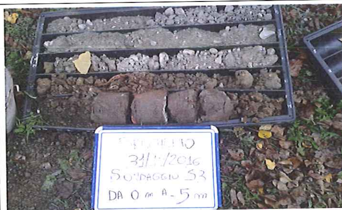
Foto 6: cassetta catalogatrice contenente i primi 5 metri di carota di terreno del sondaggio S3 (da p.c. sino a -5 m di profondità), suddivisa in 5 spezzoni ognuno della lunghezza di un metro. Per la descrizione dei sedimenti si rimanda alla stratigrafia riportata in allegato 4
