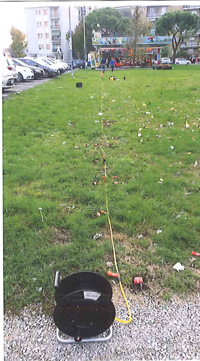
Foto 16: esecuzione indagine di approfondimento sismico mediante stendimento di linea sismica multicanale (ripresa fotografica da est verso ovest)
