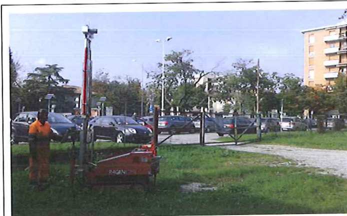
Foto 1: prova penetrometrica dinamica "P9"
