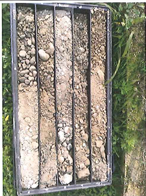
Foto 5: cassetta catalogatrice contenente i successivi 5 metri di carota di terreno del sondaggio S2 (da -5 m a -10 m da p.c.), suddivisa in 5 spezzoni ognuno della lunghezza di un metro. Per la descrizione dei sedimenti si rimanda alla stratigrafia riportata in allegato 4
