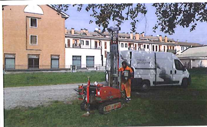
Foto 2: prova penetrometrica dinamica "P10"
