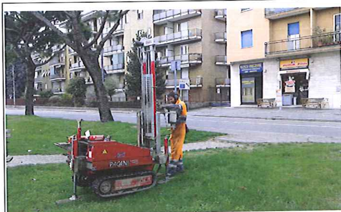
Foto 1: prova penetrometrica dinamica "P7"
