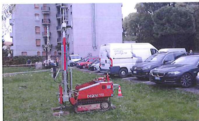
Foto 2: prova penetrometrica dinamica "P2"
