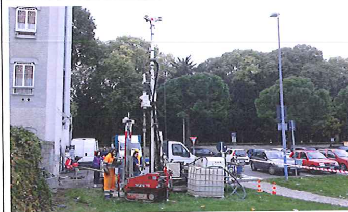
Foto 6: prova penetrometrica dinamica "P6"
