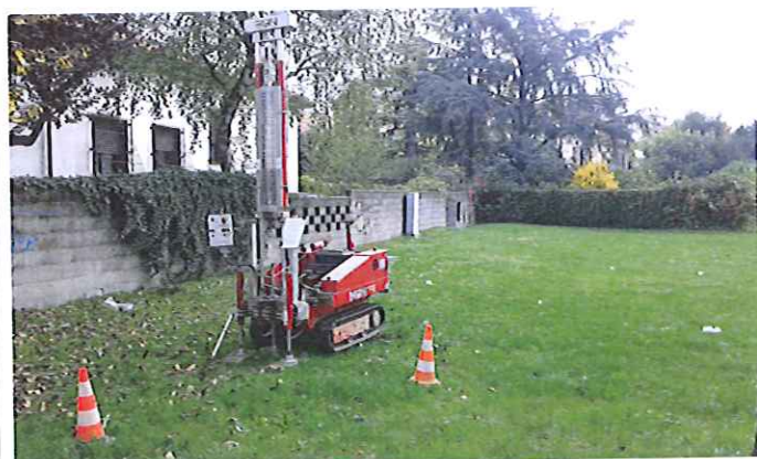
Foto 2: prova penetrometrica dinamica "P8"
