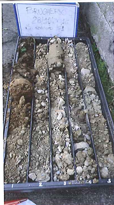
Foto 8: cassetta catalogatrice contenente i primi 5 metri di carota di terreno del sondaggio S1 (da p.c. sino a -5 m di profondità), suddivisa in 5 spezzoni ognuno della lunghezza di un metro. Per la descrizione dei sedimenti si rimanda alla stratigrafia riportata in allegato 4
