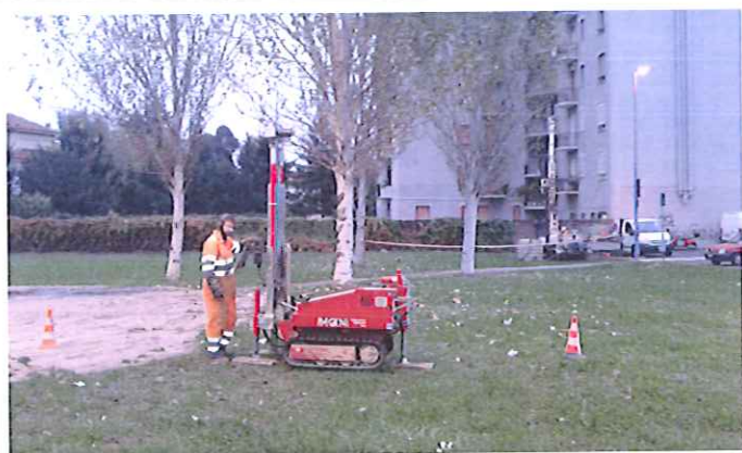
Foto 1: prova penetrometrica dinamica "P1"
