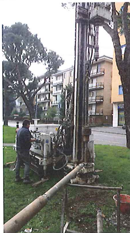
Foto 8: esecuzione prova SPT
