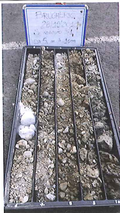
Foto 9: cassetta catalogatrice contenente i successivi 5 metri di carota di terreno del sondaggio S1 (da -5 m a -10 m da p.c.), suddivisa in 5 spezzoni ognuno della lunghezza di un metro. Per la descrizione dei sedimenti si rimanda alla stratigrafia riportata in allegato 4
