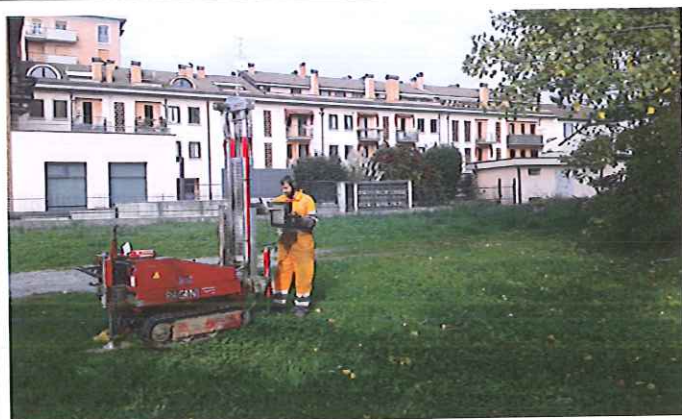
Foto 3: prova penetrometrica dinamica "P11"
