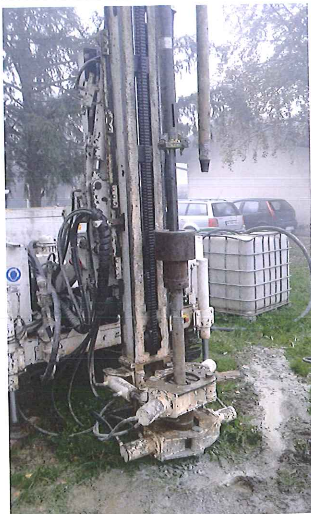
Foto 10: esecuzione prova SPT (il maglio è stato sganciato ed è andato a percuotere le aste infiggenti nel terreno)
