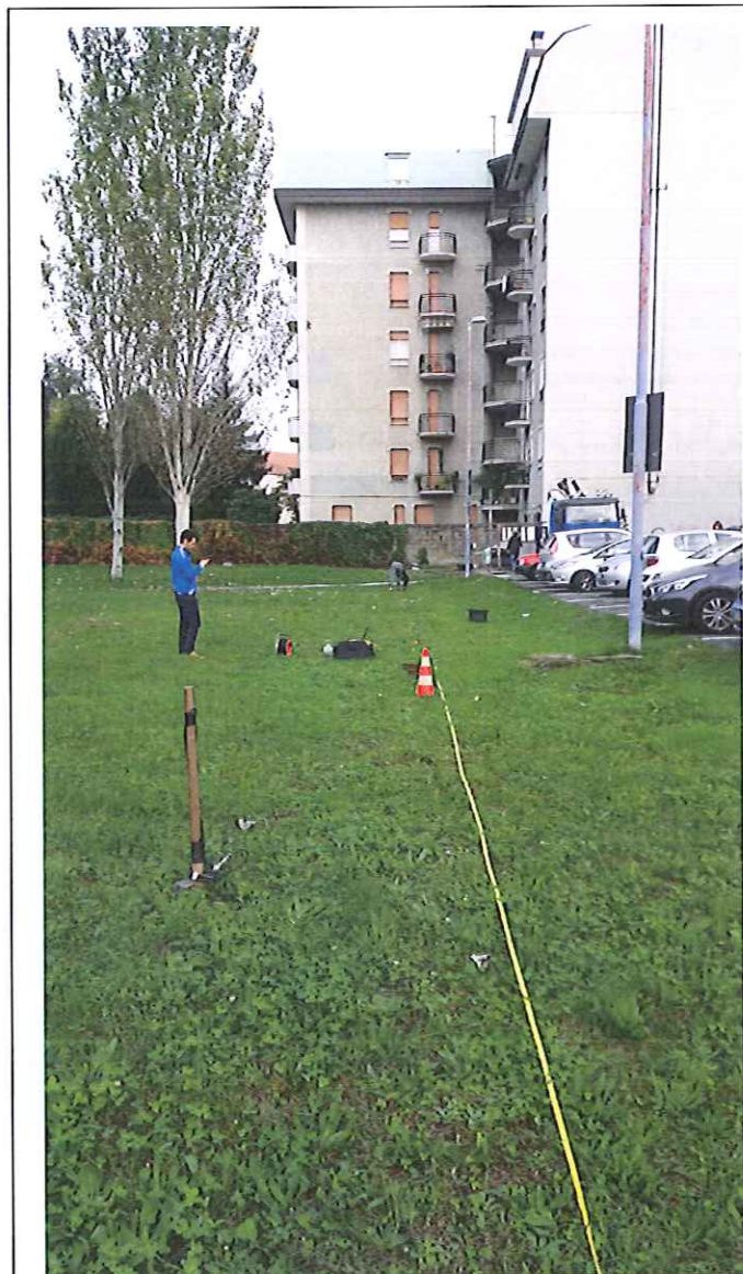
Foto 15: esecuzione indagine di approfondimento sismico mediante stendimento di linea sismica multicanale (ripresa fotografica da ovest verso est)
