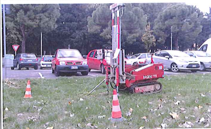
Foto 5: prova penetrometrica dinamica "P5"
