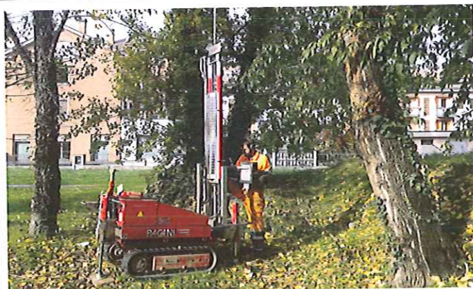
Foto 4: prova penetrometrica dinamica "P12"
