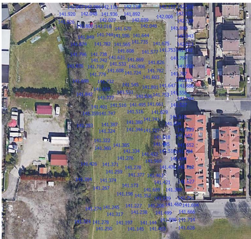
Figura 5.1 – Rilievo topografico di dettaglio – progetto GIS con base Google Satellite dell'area di intervento
