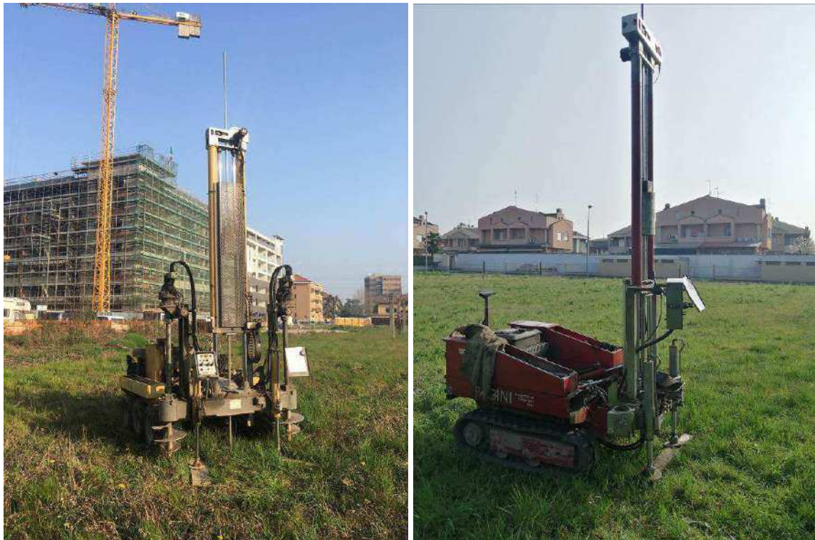
Esecuzione delle prove penetrometriche.
