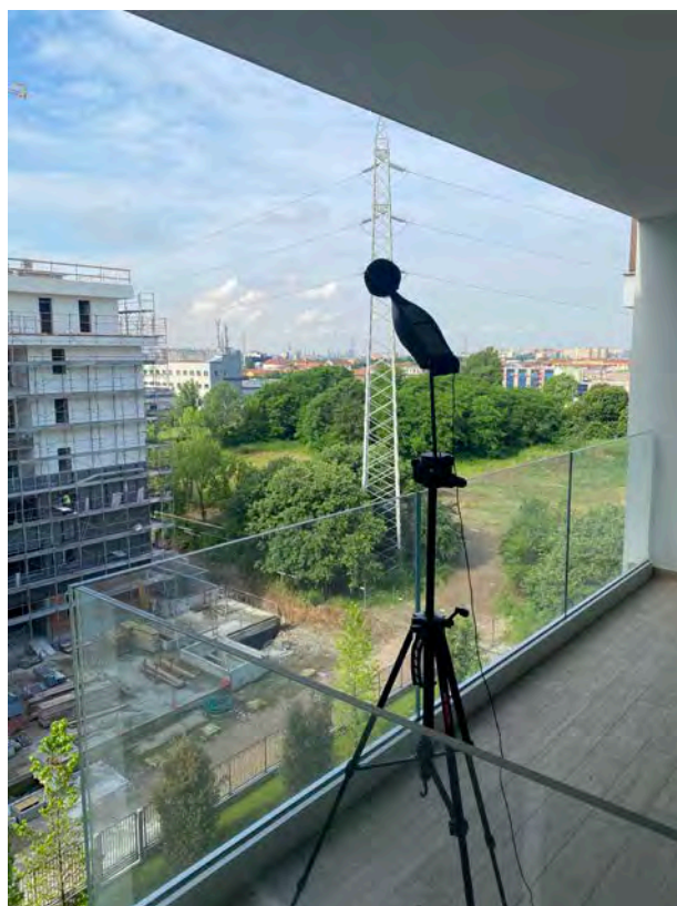
Foto 5: Fonometro posto in PointE (misurazione di 24 ore), presso un appartamento della palazzina R1 già edificata
